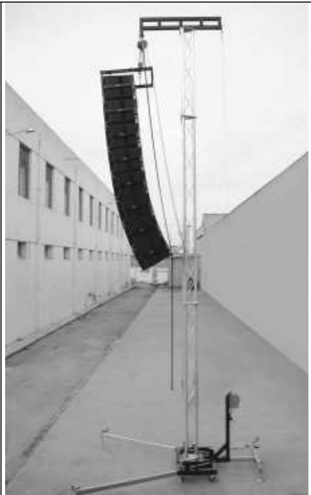
Torre montada y sistema volado
